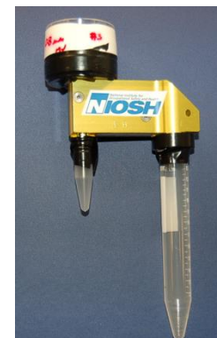
NIOSH air sampler d_{50} 2,1 \mu m - 0,41 \mu m
